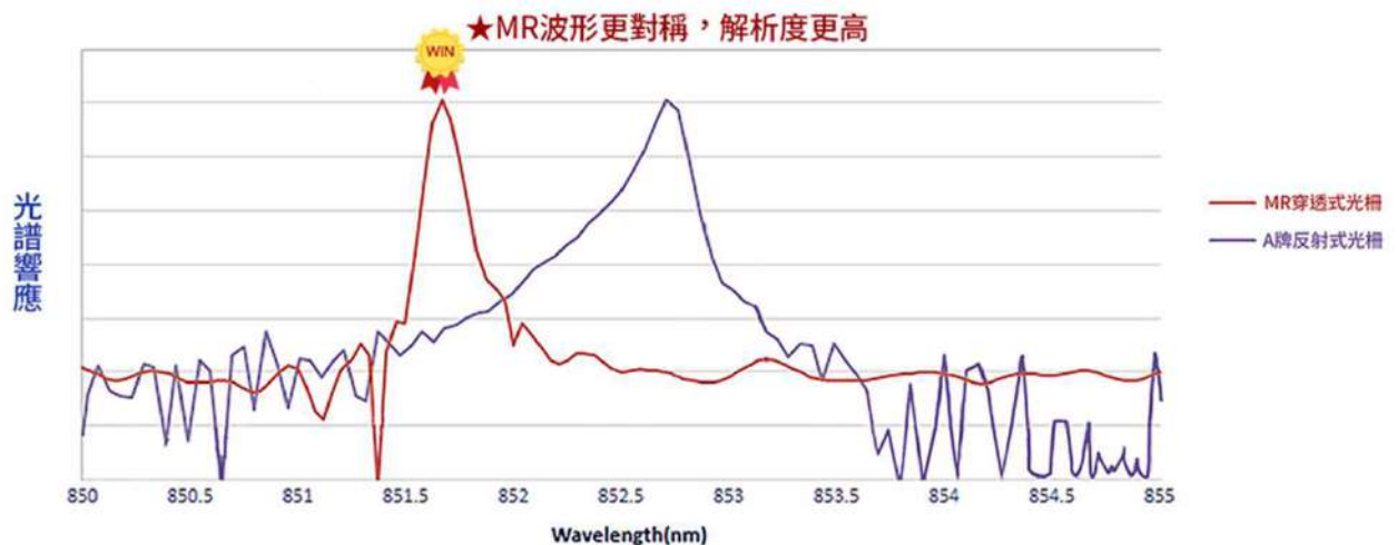
Fig. 3 : MR1080系列 VCSEL雷射响应图谱
